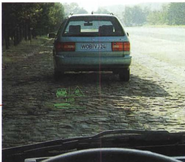
Fig. 17: Il sistema di visualizzazione direttamente sulla linea di vista del guidatore (Head Up Display) progettato e realizzato da Volkswagen.
